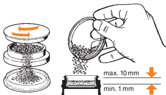
Fill filling chamber
